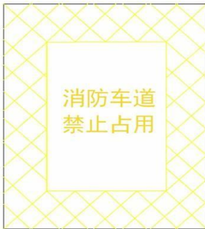
图 3：消防车通道禁止占用警示牌示例
